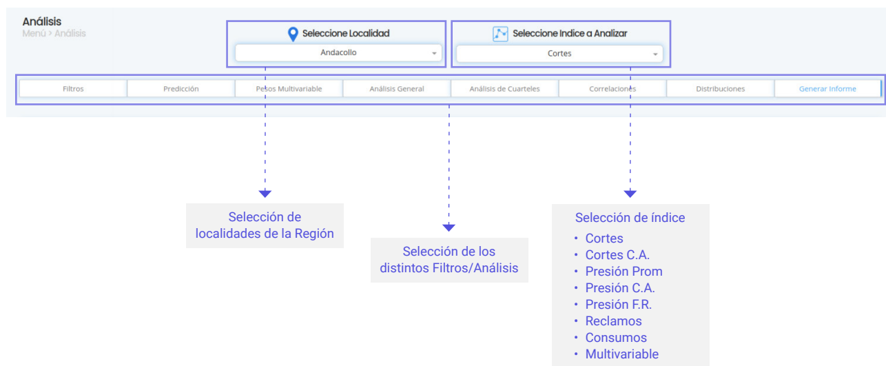
Figura 22. Pantalla inicial de la aplicación de Análisis. Esta permite seleccionar localidades, índices y fechas, y además aplicar filtros sobre las características propias de cada índice de calidad del servicio.
